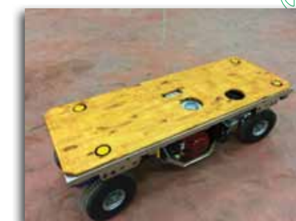
CM 80 option quatre vérins de levage et couronne tournante au centre du plateau.
